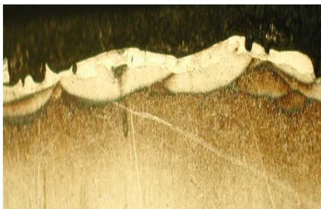
Rys. 4.113. Fotografia mikrostruktury metalograficznej zglądu poprzecznego. Próbka 34P: stal C45 stopowana elektroiskrowo elektrodą z węgla spiekanego wolframu w środowisku nafty; I = 48 \text{ A} , t_i = 100 \mu\text{s} , czas obróbki 5 min, G_{wb} = 60 \mu\text{m} ; powiększenie \times 100
