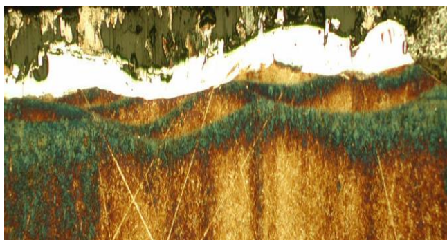
Rys. 4.95. Fotografia mikrostruktury metalograficznej zglądu poprzecznego. Próbka 30L: stal C45 stopowana elektroiskrowo elektrodą wolframową w środowisku nafty; I = 24 \text{ A} , t_i = 400 \mu\text{s} , czas obróbki 5 min, G_{wb} = 44 \mu\text{m} ; powiększenie \times 100
