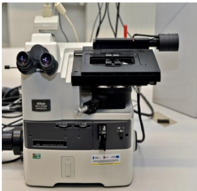
Rys. 4.7. Mikroskop metalograficzny świetlny typu odwróconego Nikon Eclipse MA 200 z systemem cyfrowej analizy obrazu NIS 4.2
