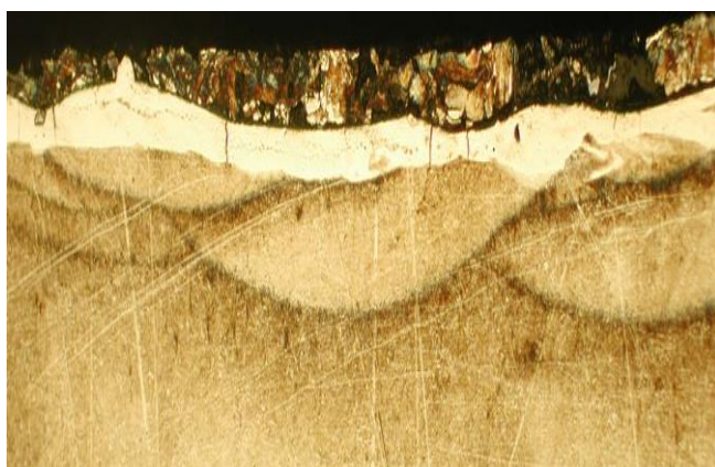
Rys. 4.114. Fotografia mikrostruktury metalograficznej zglądu poprzecznego. Próbka 34L: stal C45 stopowana elektroiskrowo elektrodą z węgla spiekanego wolframu w środowisku nafty; I = 48 \text{ A} , t_i = 400 \mu\text{s} , czas obróbki 5 min, G_{wb} = 50 \mu\text{m} ; powiększenie \times 100
