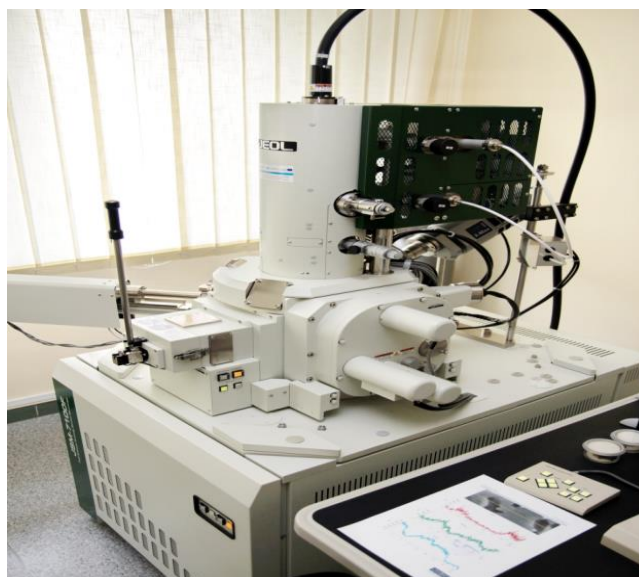
Rys. 4.6. Fotografia mikroskopu skaningowego Jeol JSM 7100F z mikroanalizatorem rentgenowskim OXFORD XRD
