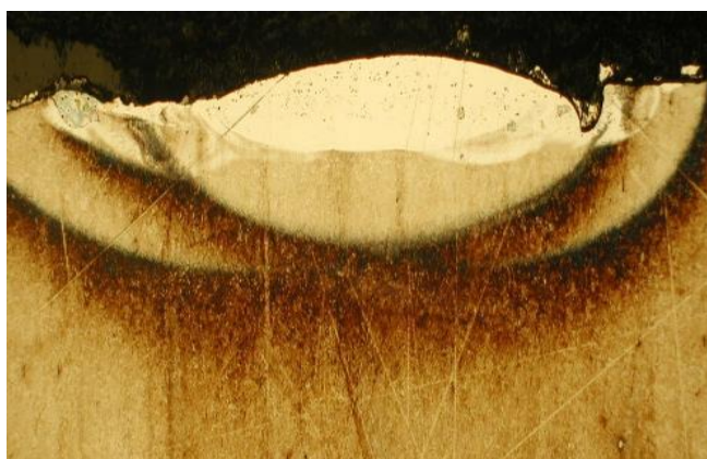
Rys. 4.112. Fotografia mikrostruktury metalograficznej zglądu poprzecznego. Próbka 36P: stal C45 stopowana elektroiskrowo elektrodą z węgla spiekanego wolframu w środowisku nafty; I = 32 \text{ A} , t_i = 3200 \mu\text{s} , czas obróbki 5 min, G_{wb} = 69 \mu\text{m} ; powiększenie \times 100
